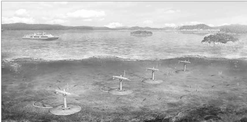
바닷물의 흐름을 이용해 전기를 생산하는 착저형 조류발전기 구상도.
